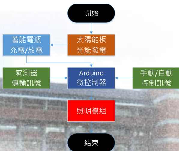
綠能發電家庭節能系統-流程簡化圖
